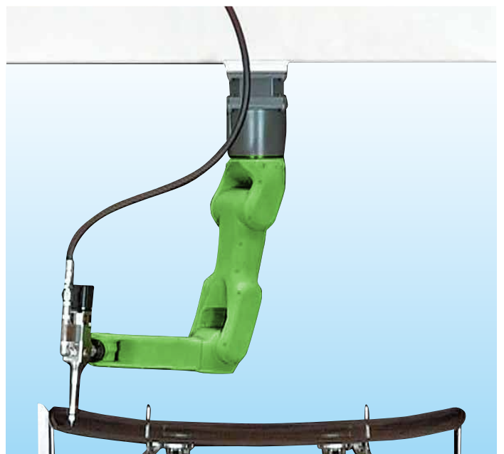
对汽车前窗玻璃进行涂胶（顶吊安装）
