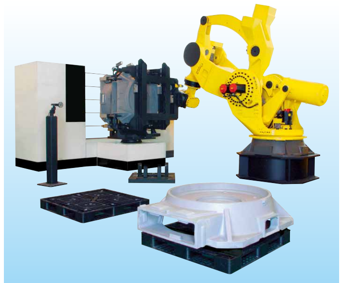
使用M-2000iA/1200把大型铸件装上机械加工用夹具
