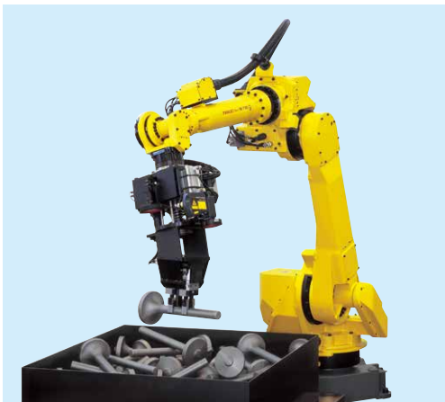
散堆圆柱形工件的拾取
