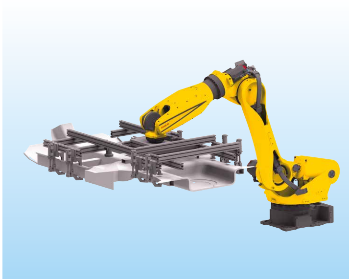
大型工件搬运
